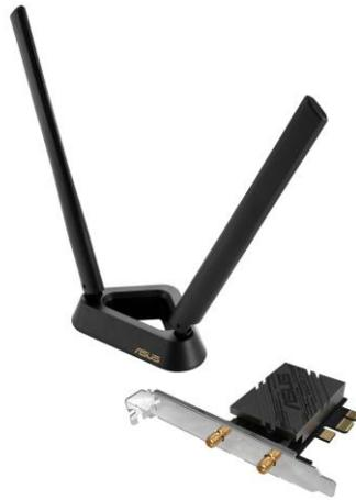
Anschluss: PCI-Express x1, Geschwindigkeit: bis 5764 Mbit (bei 6GHz) bzw. bis 2882 Mbit (bei 5GHz) bzw. bis 688 Mbit (bei 2.4GHz) Verschlüsselung: WPA3, Standard: 802.11 a/b/g/n/ac/ax/be (WiFi 7), Bluetooth 5.4
