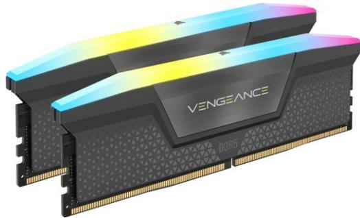
Spezifikation: 6000 MHz, 288-Pin, CL30 XMP 3.0 Unterstützung, 1.35V, Besonderheit: Beleuchtung
