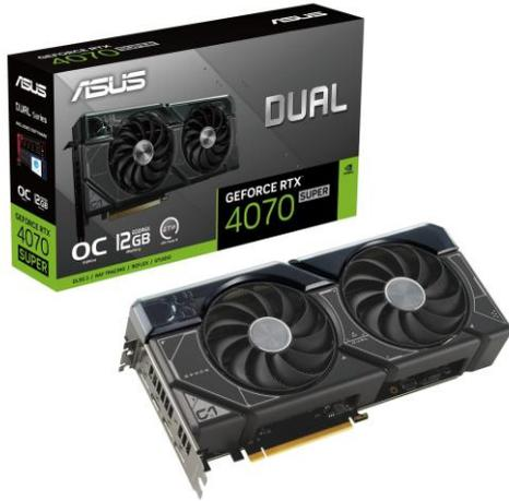
PCI-Express 4.0 (x16), Speicher: 12GB GDDR6X, Anschluß: Display-Port1.4a, HDMI2.1 Chipsatz: NVIDIA GeForce® RTX 4070 Super, DLSS3
