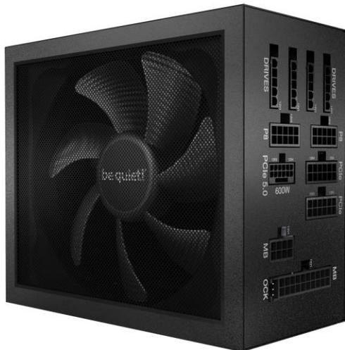
Unterstützt: ATX (20pol.) und ATX EPS (24pol.), Lüfter: 13.5cm
