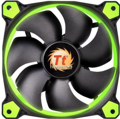
Abmessung: 140 x 140 x 25mm, Lautstärke: 22.1 dBA Anschluß: 3 Pin + Low-Noise Adapter, Umdrehungen: 1000rpm mit Adapter; AirFlow: 51.15 CFM
